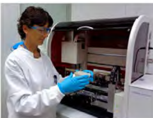
Die Untersuchung der DNA-Strangbrüche erfolgt mithilfe des automatisierten FADU-Assays, den María Moreno-Villanueva während ihrer Doktorarbeit im Labor von Professor Alexander Bürkle in Konstanz weiterentwickelt und optimiert hat. © Universität Konstanz
